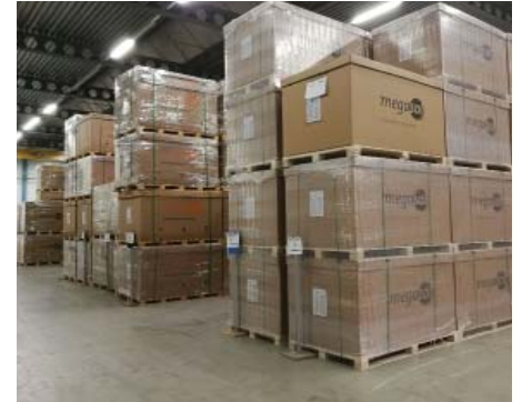
Blocklager bis 5m Höhe
